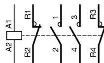
**Дополнительные контактные блоки фронтального монтажа**
