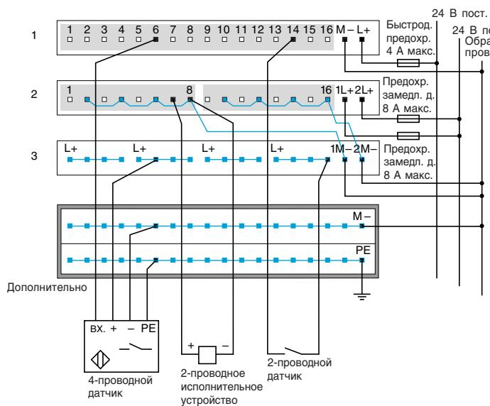
Пример наружной разводки 3-проводного исполнительного устройства с контролем проводки
