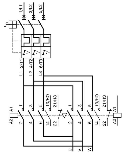
Механическая блокировка со встроенными электрическими контактами
