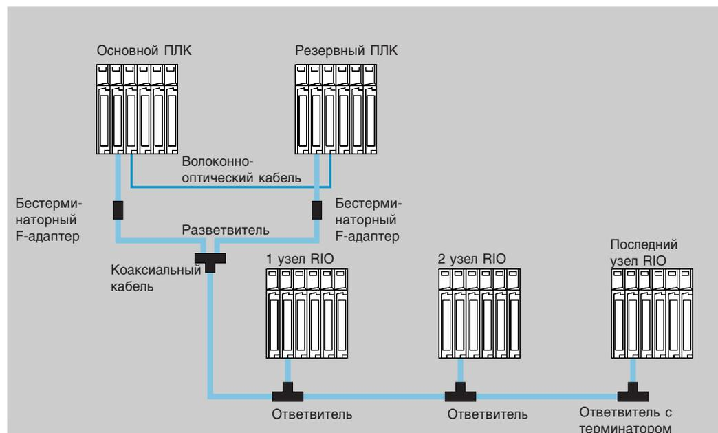
Система горячего резерва также поддерживает топологию кабельные системы RIO с резервированием. Коаксиальные кабели от двух портов на адаптерах головного узла 140 CRP 932 00 в двух контроллерах подсоединяются к резервному кабелю RIO отдельными разветвителями MA-0186-100.
