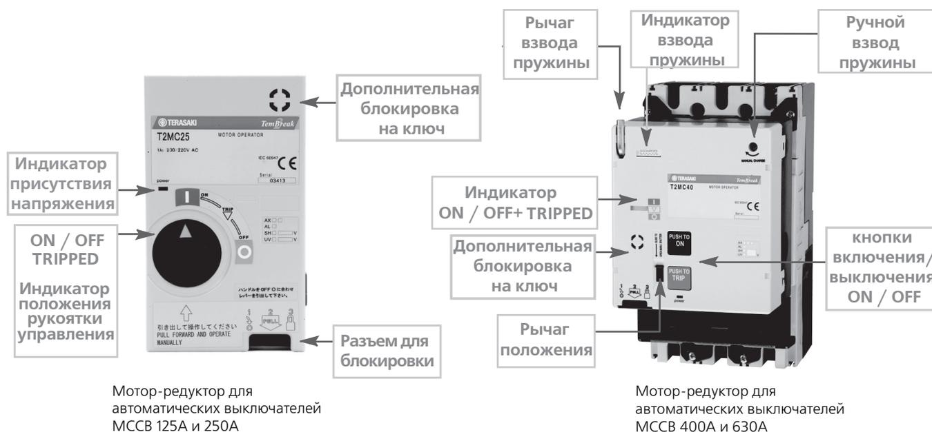
Мотор-редукторы обеспечивают возможность размыкания или замыкания автоматического выключателя **MCCB** при подаче электрического управляющего сигнала. Мотор-редукторы **TemBreak 2** очень надежны и спроектированы с такой же переключающей способностью как и у базового автоматического выключателя базового **MCCB**.
