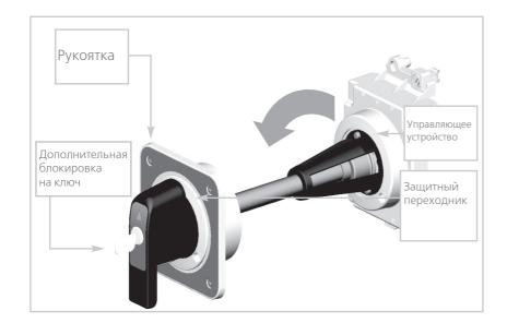
Рукоятка смонтированная на двери используется ДЛЯ управления автоматом, установленным внутри шкафа. Она состоит из управляющего механизма, установленного на автомате, рукоятки установленной на двери и штанги-удлинителя, которая передает усилие с рукоятки на управляющий механизм. Штангу-удлинитель можно обрезать до требуемой длины.
